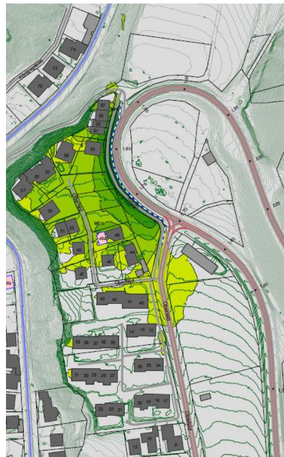
Abbildung 24: Differenzlärmkarte, Immissionshöhe 4,0 m über Gelände
