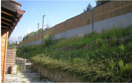
Abbildung 5: Lärmmessung zur Evaluierung der Lärmschutzwände
