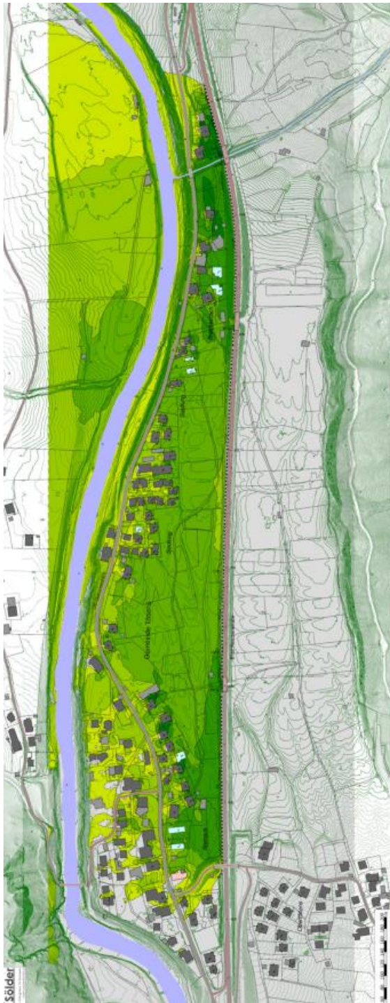
Abbildung 22: Differenzlärmmkarte Variante 1, Immissionshöhe 4,0 m über Gelände
