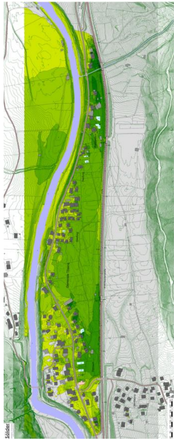
Abbildung 23: Differenzlärmmkarte Variante 2, Immissionshöhe 4,0 m über Gelände
