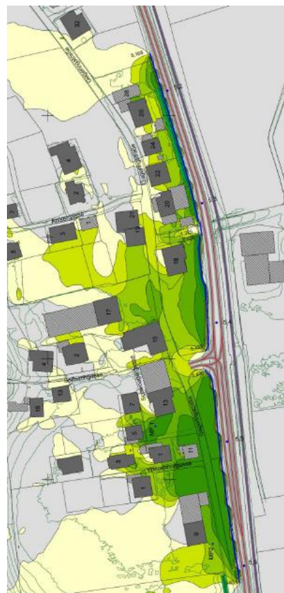
Abbildung 2: Differenzlärmmkarte Lärmschutz Gagering, km 5,1 bis km 5,6
